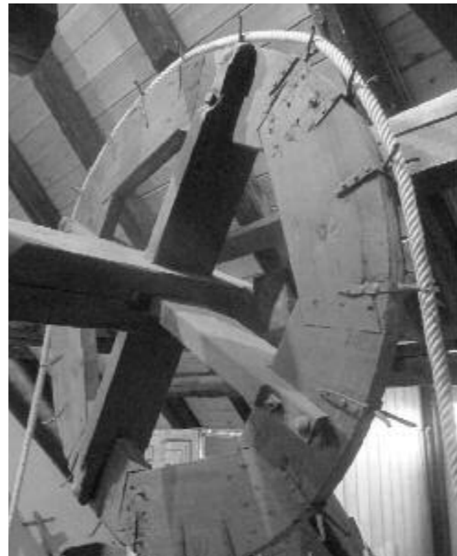
Seil im Einsatz am Lastenaufzugsrad im Speichergebälk auf dem Dachboden
